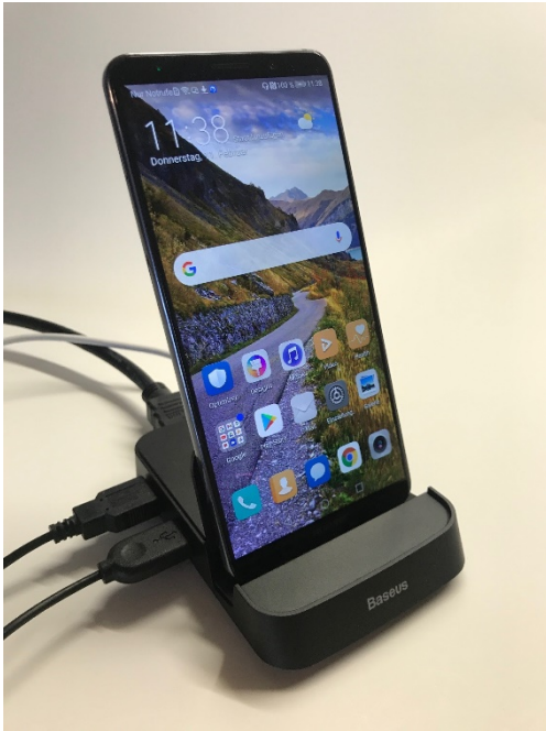
Abb: USB-Dock mit Anschlüssen für Tastatur, Maus, Monitor und Stromversorgung
